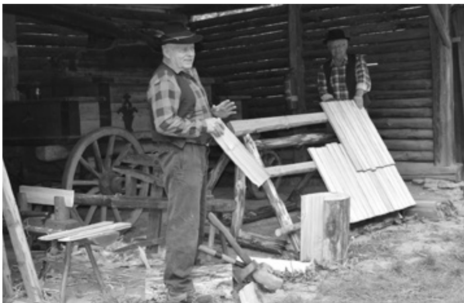
Obr. 9, 10. Demonštračné ukážky výroby a kladenia šindľov a výroby dreveného odkvapového žlabu počas workshopu Tesárske a šindliarske technológie. Foto M. Kiripolská, 2019
