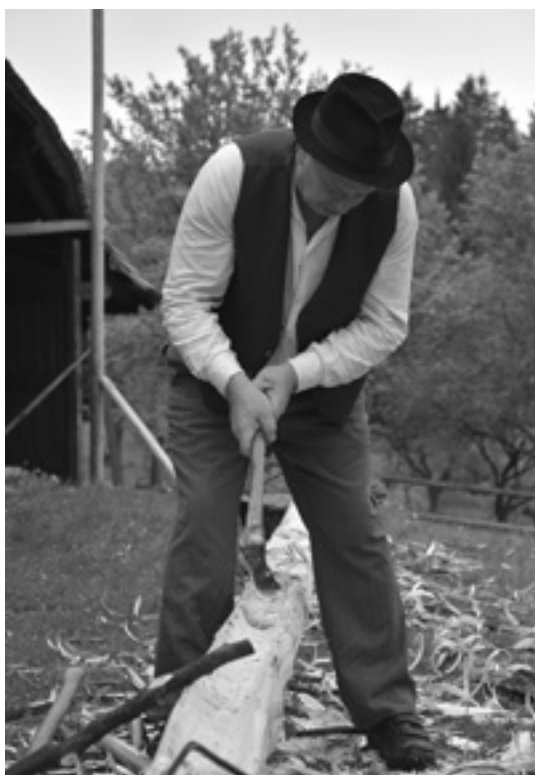
Obr. 9, 10. Demonštračné ukážky výroby a kladenia šindľov a výroby dreveného odkvapového žlabu počas workshopu Tesárske a šindliarske technológie. Foto M. Kiripolská, 2019
